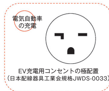
抜止形コンセントの極配置 (JIS C 8303 付図A-17)
