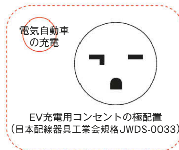
抜止形コンセントの極配置 (JIS C 8303 付図A-17)
