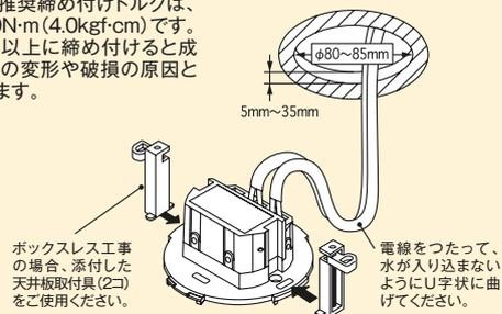
ボックスレス工事の場合、添付した天井板取付具(2コ)をご使用ください。
