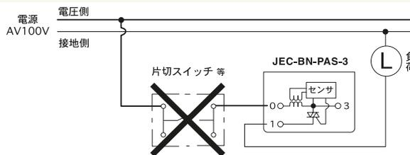
壁用 埋込感熱センサスイッチ 4線式 明るさセンサ付
