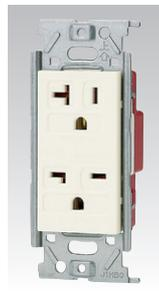
**attention!!** 15A・20A兼用コンセントは20A配線用遮断器分岐回路の専用回路に、1個のみ・太さ2.0mmの電線で接続してください。
