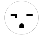
EV充電用コンセント JW-B-E3202の極配置 (日本配線器具工業会規格 JWDS-0033)
