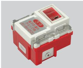
■ 照明操作と換気扇制御をひとつのスイッチで兼ねられる単極2回路タイプ。操作つまみをOFFにすると、換気扇は遅れて約3分後に止まります。照光式の操作つまみは、換気扇作動中、赤く輝いて通電状態を表示します。
