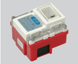
■ 照明操作と換気扇制御をひとつのスイッチで兼ねられる単極2回路タイプ。操作つまみをOFFにすると、換気扇は遅れて約3分後に止まります。照光式の操作つまみはガイド・チェック用。換気扇作動中、赤く輝いて通電状態を表示します。換気扇停止中は、操作つまみがオレンジ色に輝くので、暗闇でもスイッチの位置が簡単にわかります。
