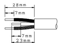
適合する圧着端子をかしめてネジ止めしてください。
